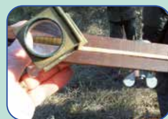
Lecture d'une carotte au dixième de millimètres
