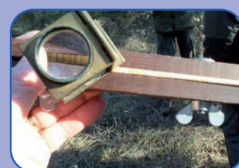
Lecture d'une carotte au dixième de millimètres
