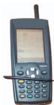
L'ordinateur de poche permettant la saisie des données et leur transmission par GPRS
