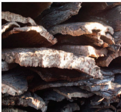
Liège femelle de faible qualité : des crevasses apparaissent et de nombreux résidus de poussières sont présents à l'intérieur du liège
