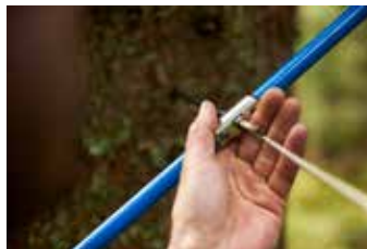
Utilisation de la tarière de Pressler
